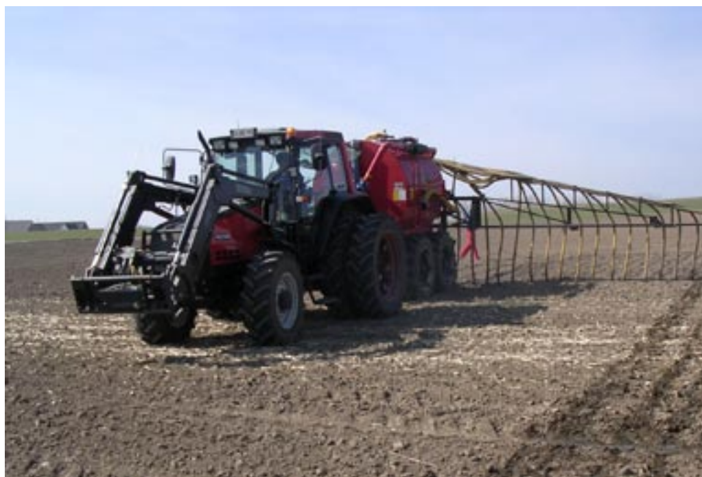
Mylla kvickt. Vid spridning är det viktigt att använda rätt utrusning och att bruka ner rötresten direkt för att minimera risken för kväveförluster. Foto: Anna Hansson
