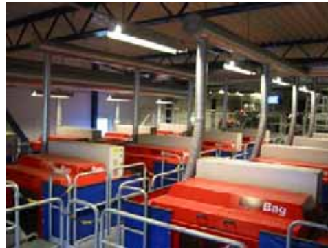
Figur 3. Avslagare i optisk sorteringsanläggning. Foto: SWECO VIAK.
