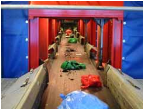
Figur 2. Färgade soppåsar på sorteringsband i optisk sorteringsanläggning. Foto: SWECO VIAK.
