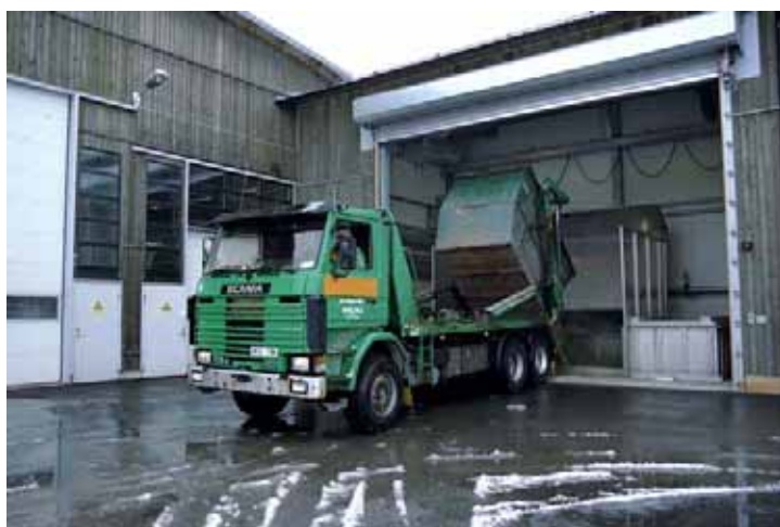
Figur 8. Mottagning i tippficka för fastavfall. Foto. SWECO VIAK
