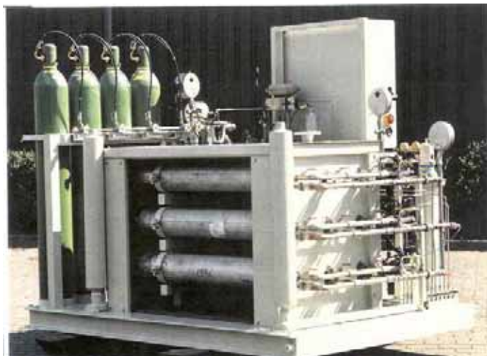
Figur 16. Exempel på en mindre gasreningssystem, typ PSA. Foto: SWECO VIAK.
