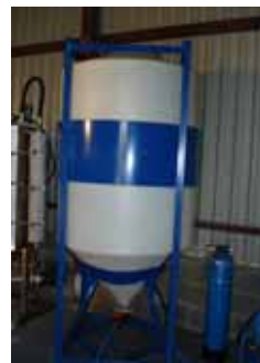
Omförestringsanläggning för RME-produktion 400 l/h
